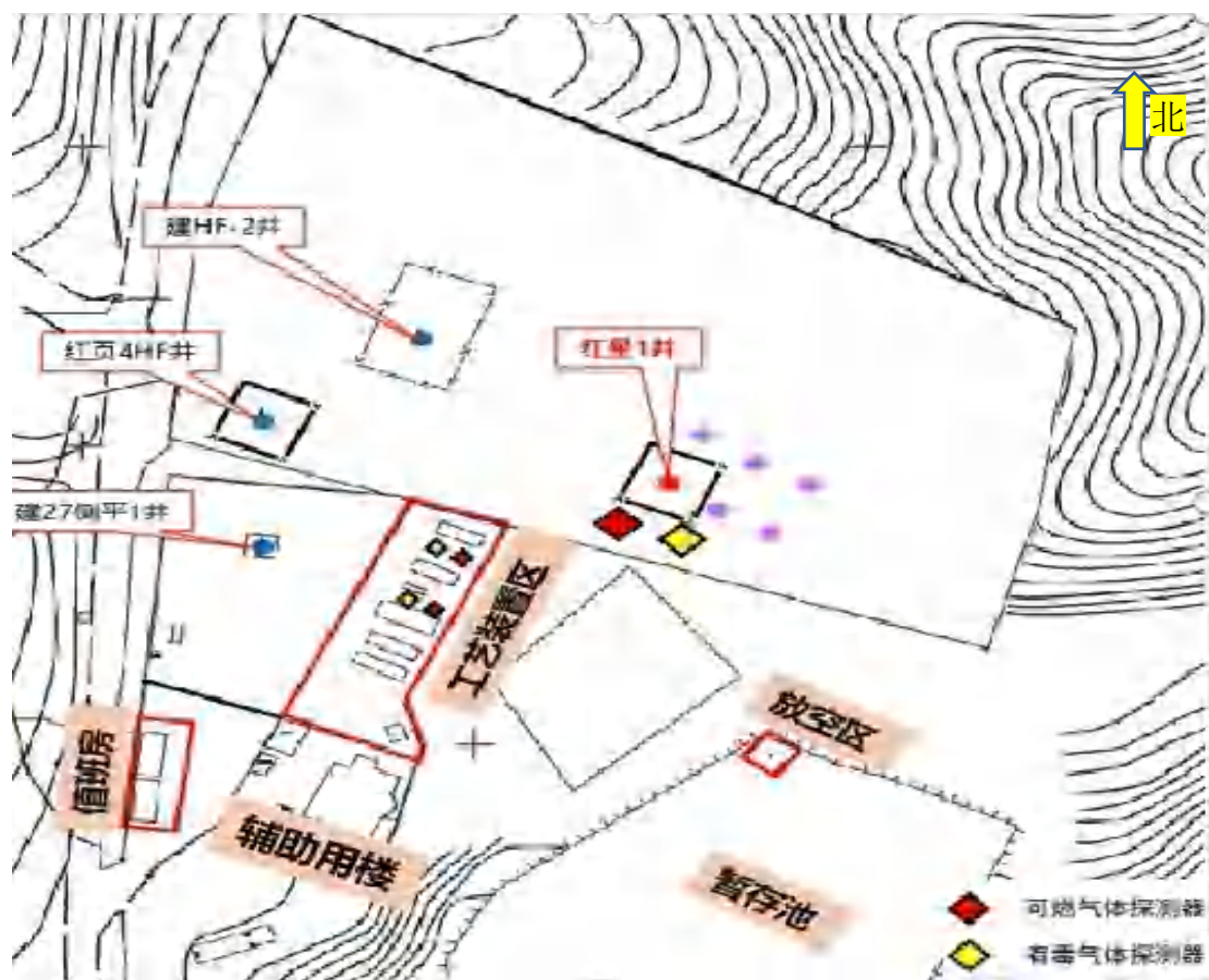
图 2.4-2 红页 4 平台新增有毒/可燃气体探测器布置示意图
