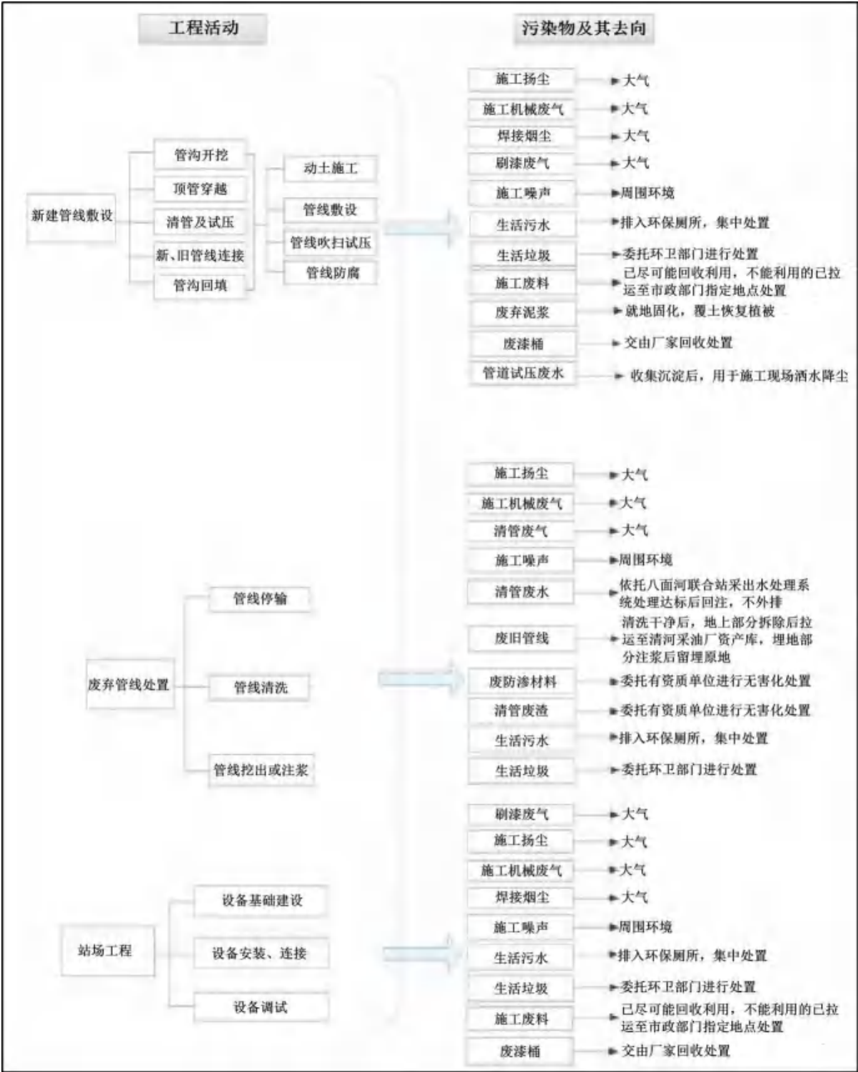
图 3.3-3 施工期工艺流程及产污环节图
